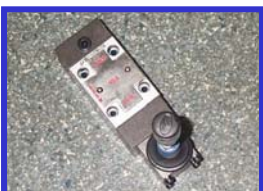
Boom control DCV HYDEN111-A
